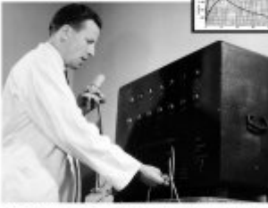
Czasomierz elektroniczny służący do mierzenia szybkości pocisków (1959r.)
